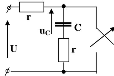
8) Электрическая цепь с последовательным соединением активного сопротивления  $R = 1000 \text{ Ом}$  и конденсатора  $C$  включается на синусоидальное напряжение  $u(t) = 1000\sin(314t + 30^\circ)$ . Подобрать такую емкость конденсатора  $C$ , при которой не будет возникать переходного процесса.
