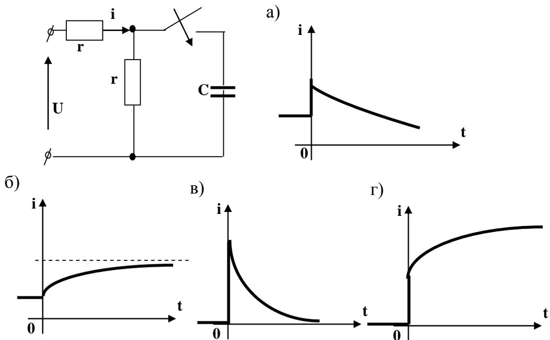
4. Определить переходной ток в цепи для указанной схемы.
